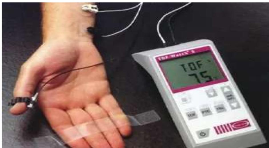
Рис.4.1 TOF-Watch монитор (Organon), основан на измерении ускорения (акцелеромиография) с пьезоэлектрическим датчиком. На дисплее TOF представлено в процентах. Видно расположение подключения электродов
